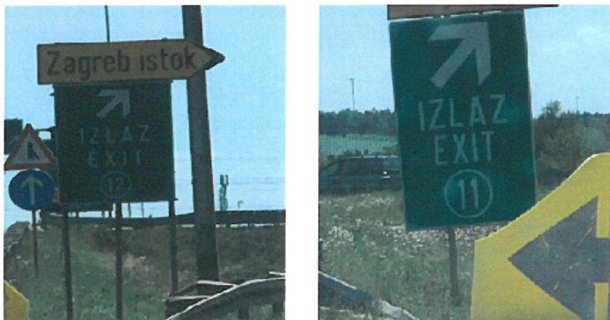
Slika 30. Primjer postavljanja znaka obavijesti C97 na autocesti A4
