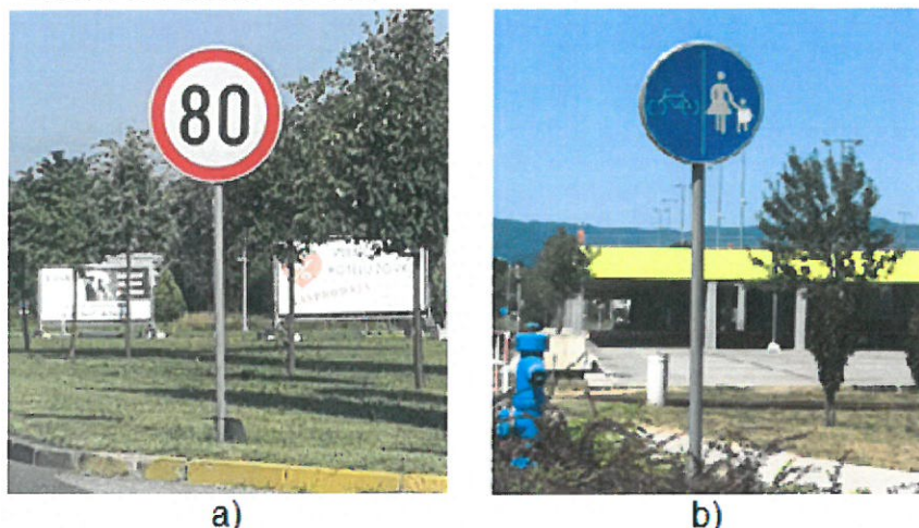
Slika 43. Primjer postavljanja znakova izričite naredbe: a) znak B31 na Slavonskoj aveniji, b) znak B48 u Ulici Siniše Glavaševića
