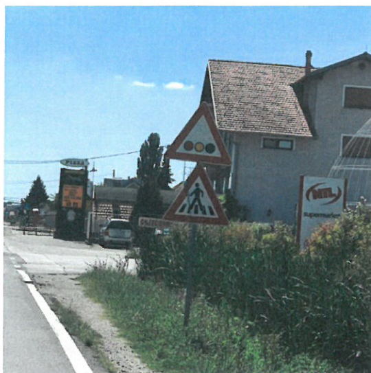
Slika 9. Primjer postavljanja znakova opasnosti A24 i A33 na državnoj cesti D3
