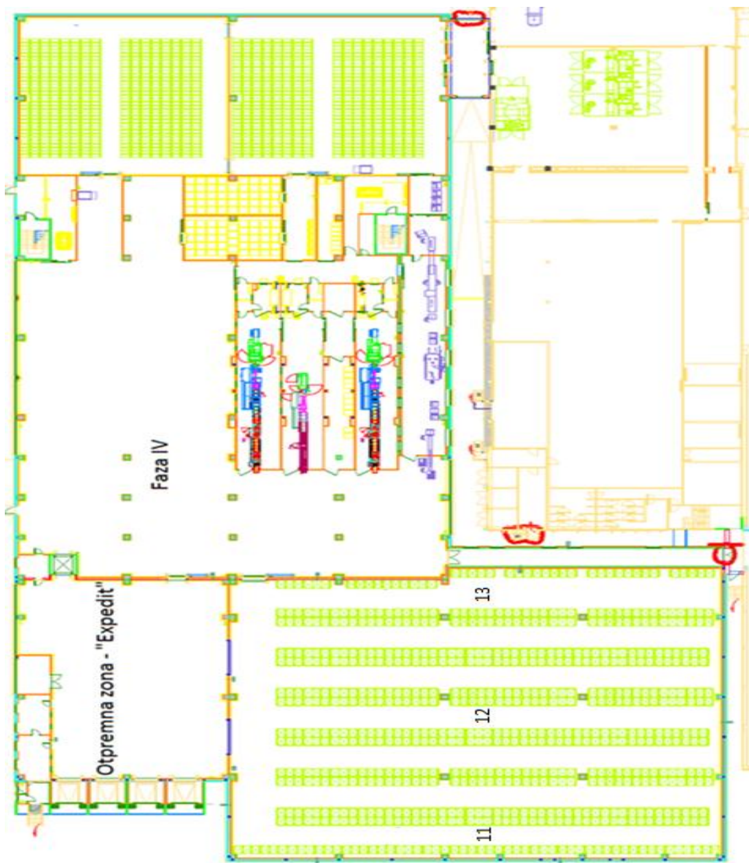
Slika 15. Tlocrt objekta sa označenim administrativnim skladištima 11, 12 i 13
