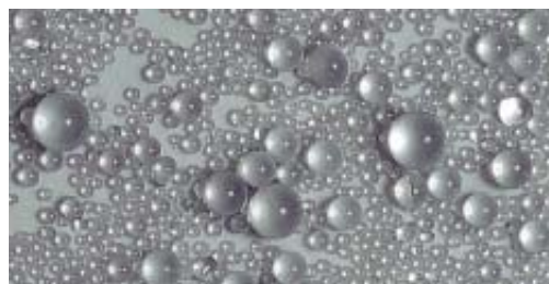
Slika 26. Megalux-beads staklene kuglice
