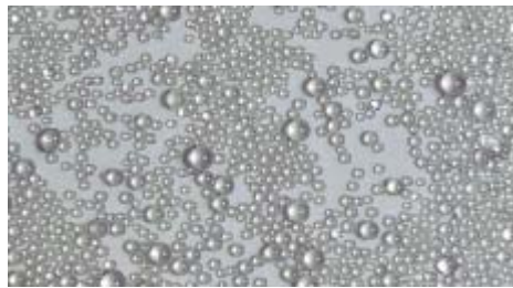
Slika 24. Swarcoflex staklene kuglice
