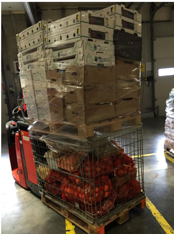
Slika 21. Primjer kombinacije iskomisionirane gitterbox palete i palete
