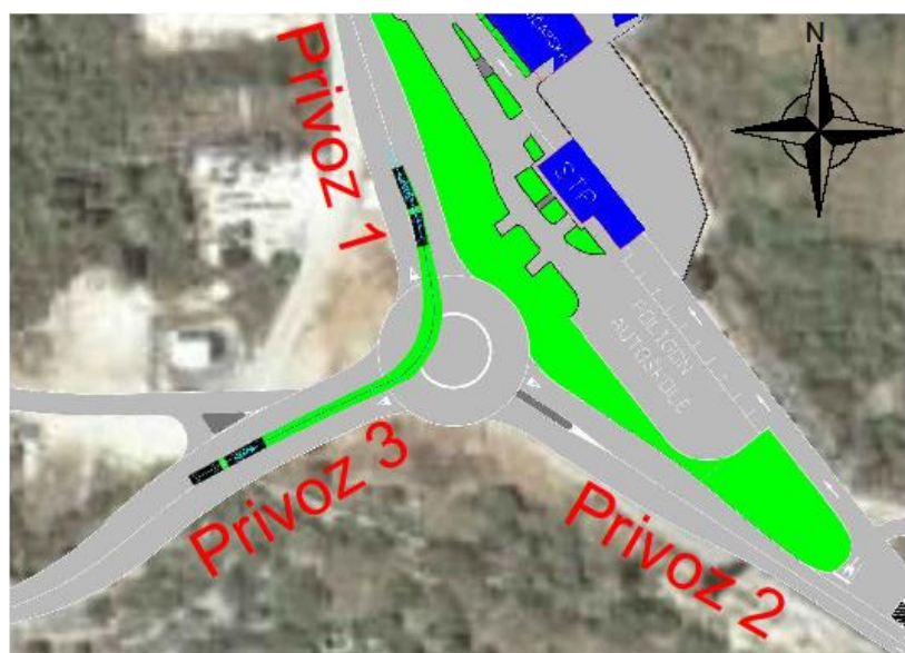
Slika 4.8. Provjera trajektorije mjerodavnog vozila na RKT Ž6222/LC69016/Ž6222
