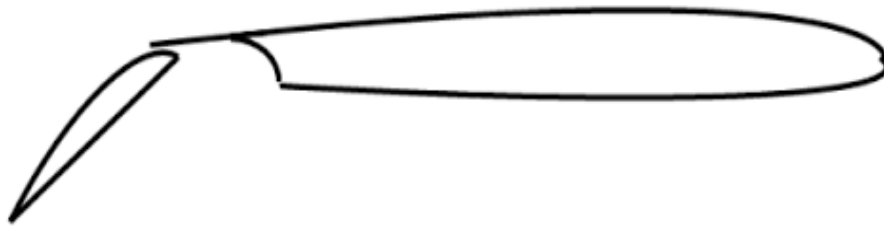
Slika 20. Prikaz Fowlerovog zakrilca
