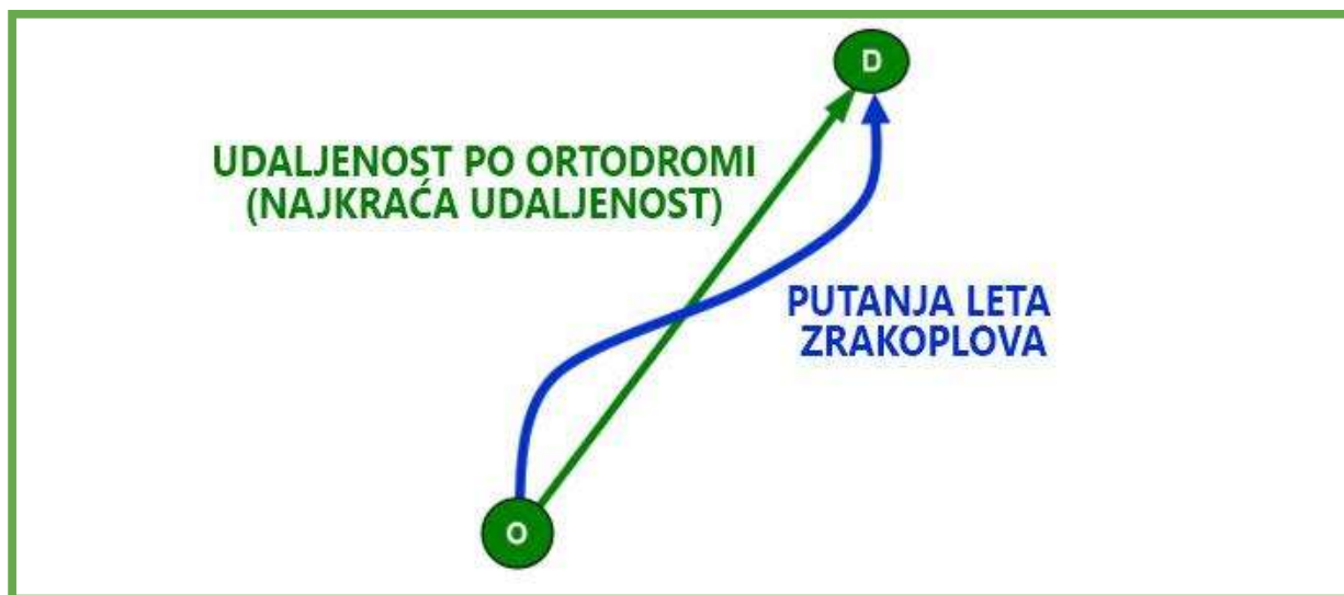
Slika 3. - Omjer između stvarne putanje zrakoplova i udaljenosti po ortodromi,
