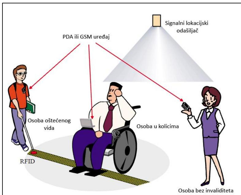
**Slika 7.** Primjer univerzalnog dizajna uz korištenje RFID tehnologije, [3]
