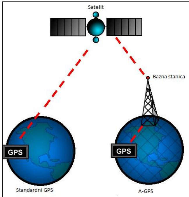
**Slika 13.** Primjer standardnog GPS-a i A-GPS-a, [24]
