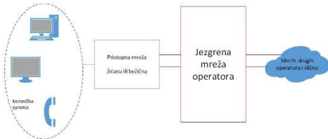
Slika 1. Segmentacija telekomunikacijske mreže [6]
