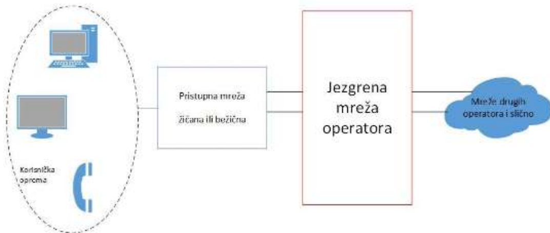
Slika 1. Segmentacija telekomunikacijske mreže [6]
