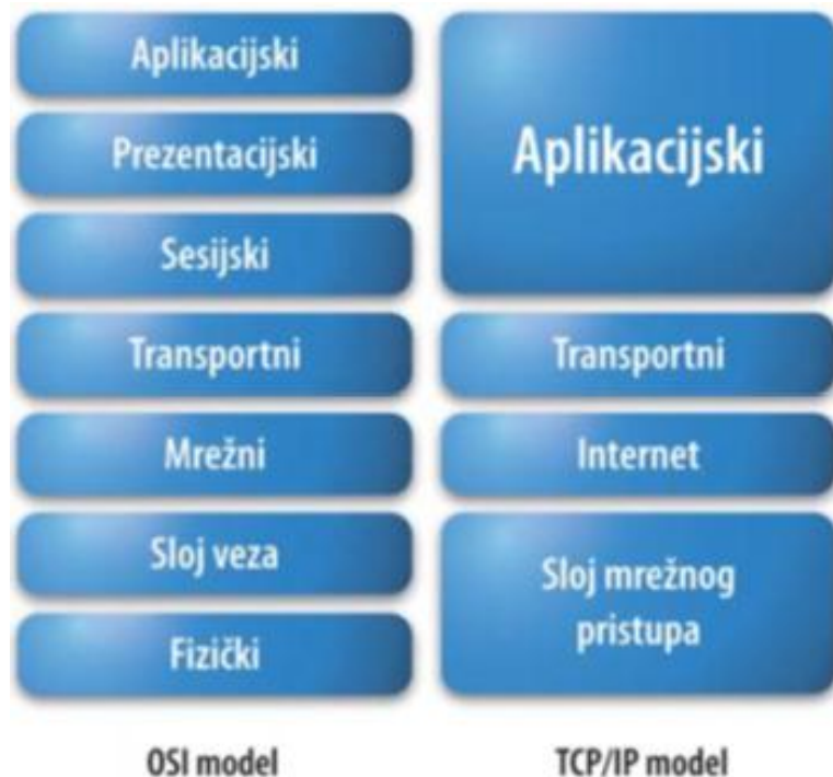
Slika 2. Razlika OSI i TCP/IP modela po slojevima [1]
