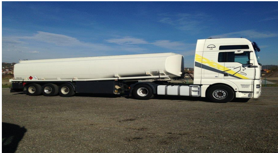
Slika 8. Kamion tegljač s dvije osovine i poluprikolicom s tri osovine
