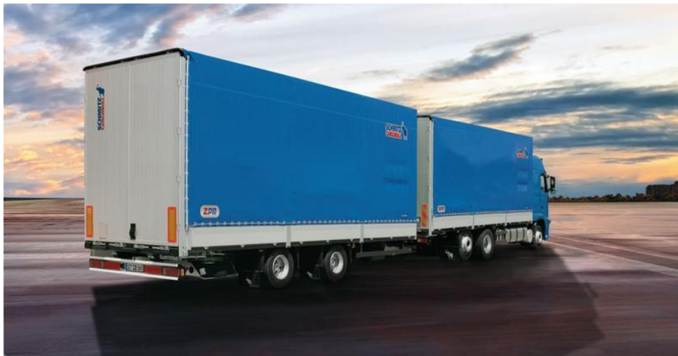
Slika 6. Kamion s tri osovine i prikolicom s dvije osovine
