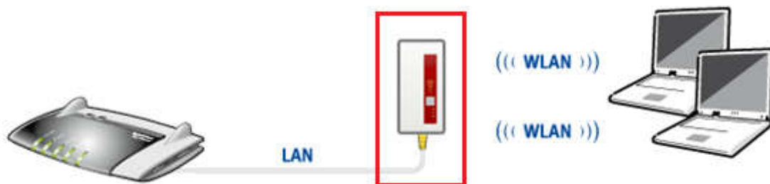
Slika 1. Prikaz žične i bežične LAN tehnologije
