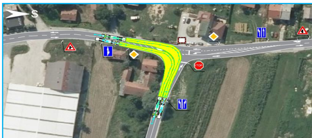
Slika 30. Trajektorija provoženja mjerodavnog vozila na raskrižju 2
