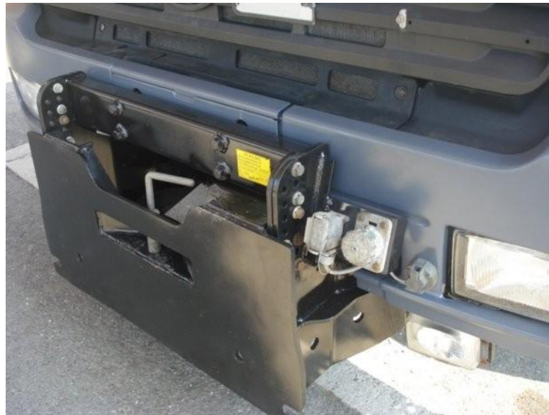
Slika 5. Prednja ploča (prihvat snježnog pluga) 10
