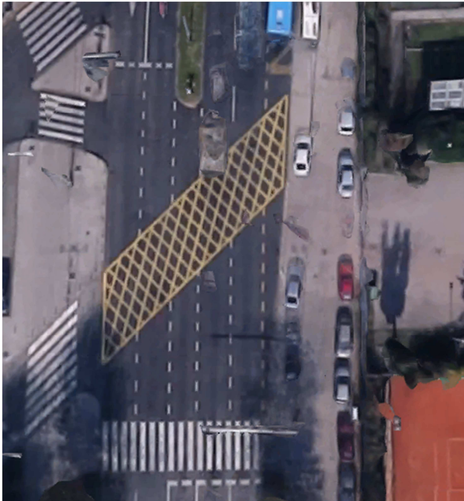
Slika 15. Prikaz "Junction Box-a" u Zagrebu Izvor: [10] (30.08.2017)
