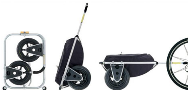
Slika 14. Carry Freedom City prikolica sklopljena, sastavljena i u uporabi
