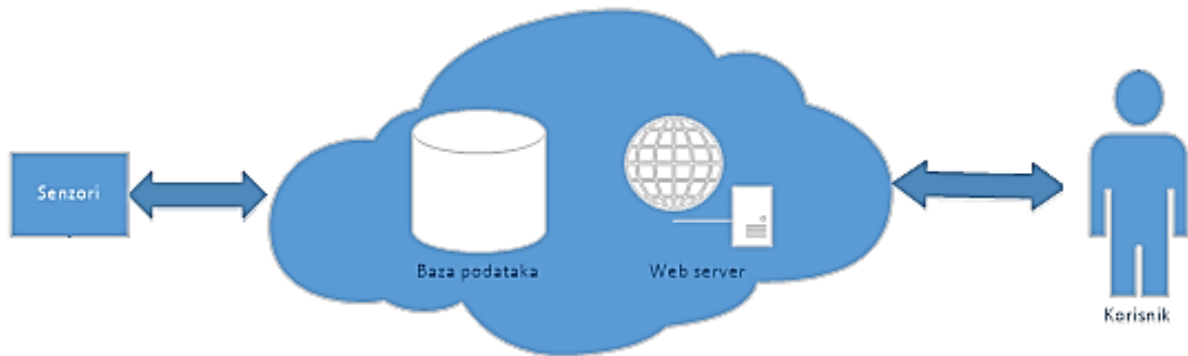
Slika 18. Arhitektura predloženog sustava
