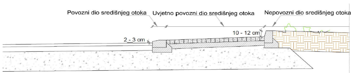
Slika 3.18. Dijelovi središnjeg otoka turbo kružnog raskrižja [7]
