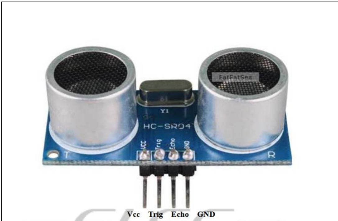
Slika 8. Ultrazvučni senzor HC-SR04 [16]
