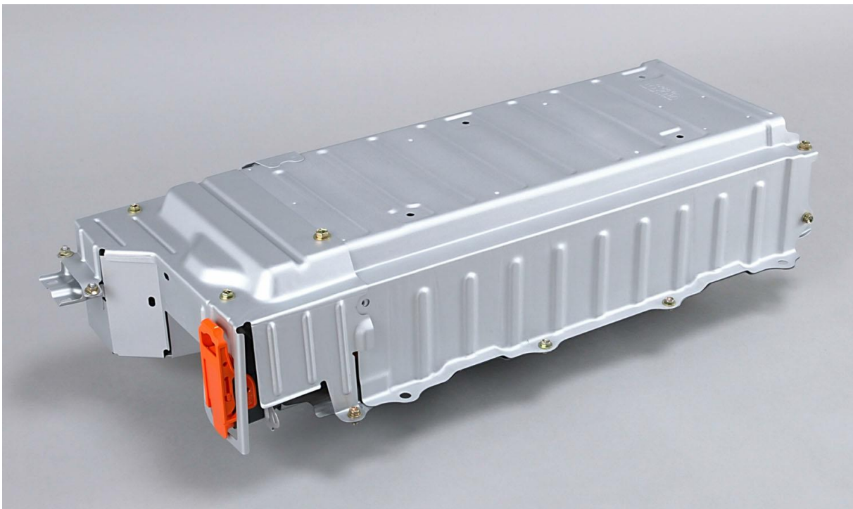
Slika 7 NiMH baterija kod Toyota Prius vozila [20]
