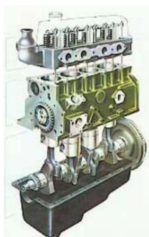
Slika 7. Glava i blok motora [7]
