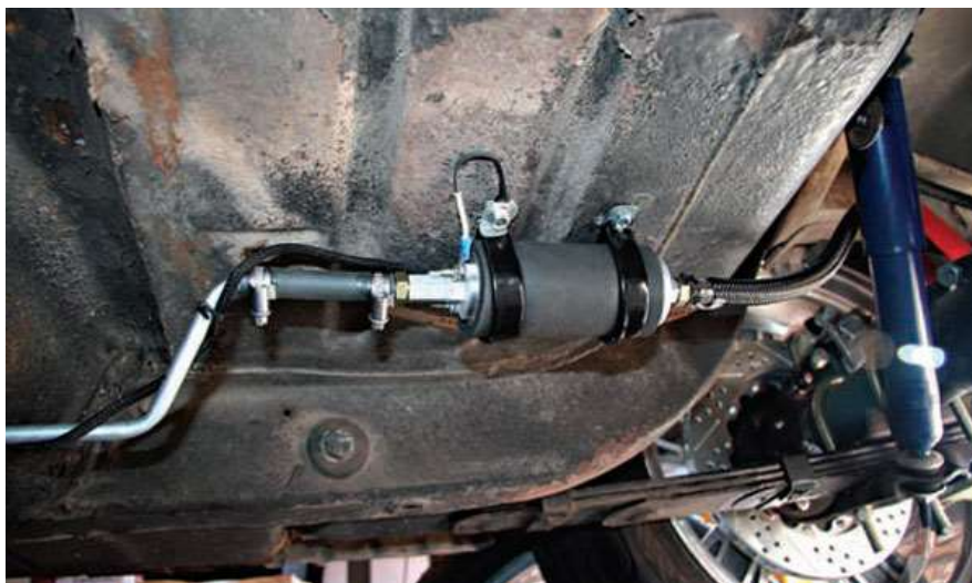
Slika 6. Električna pumpa za gorivo izvan spremnika [9]
