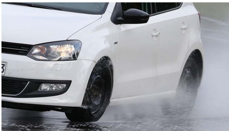
Slika 14. Primjer testiranja aquaplaninga, [24]
