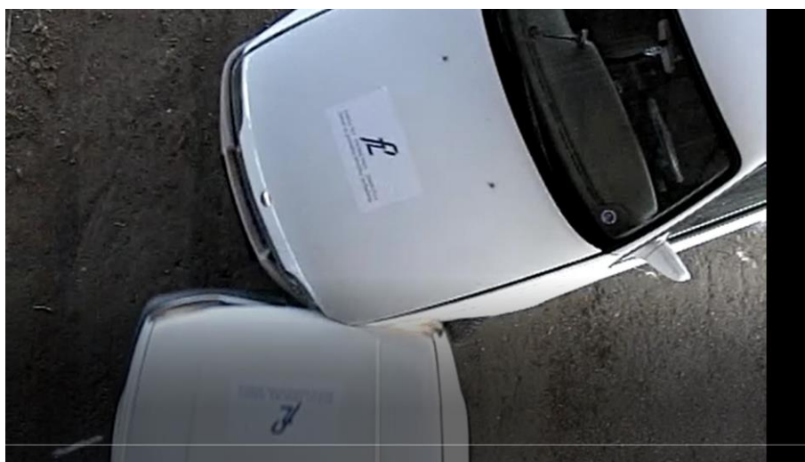
Slika 5.6. Bočni sudar vozila - pogled odozgo
