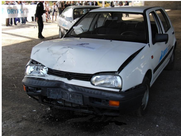
Slika 5.7. Oštećenja na vozilu VW Golf - 1
