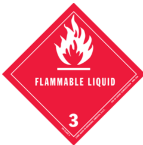
Slika 9 Primjer ploče klase 3 zapaljiva tekućina
