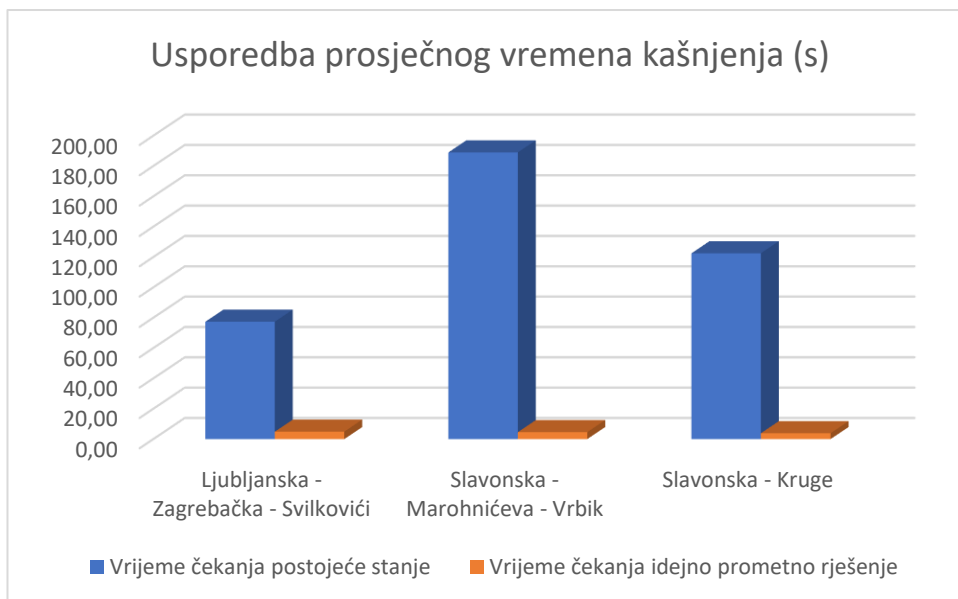
Grafikon 7.1. Usporedba prosječnog vremena kašnjenja po vozilu u postojećem stanju i idejnom prometnom rješenju
