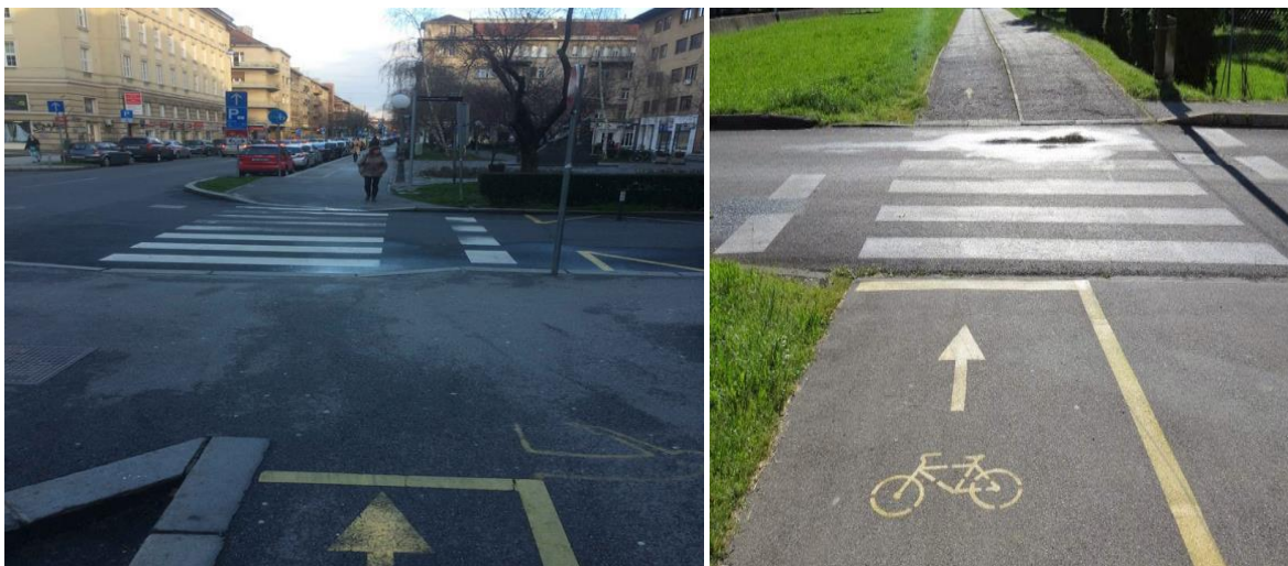
Slika 27. Prekid biciklističke staze
