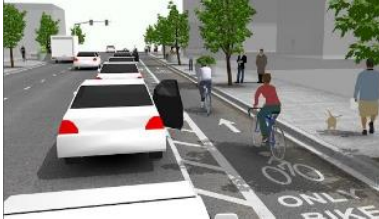
Slika 49. Biciklistička traka sa sigurnom zonom između Izvor: [5]
