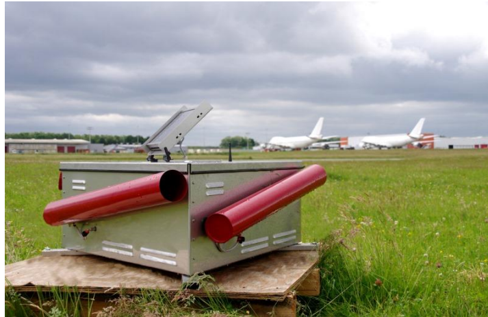
Slika 22. Prikaz plinskih topova
