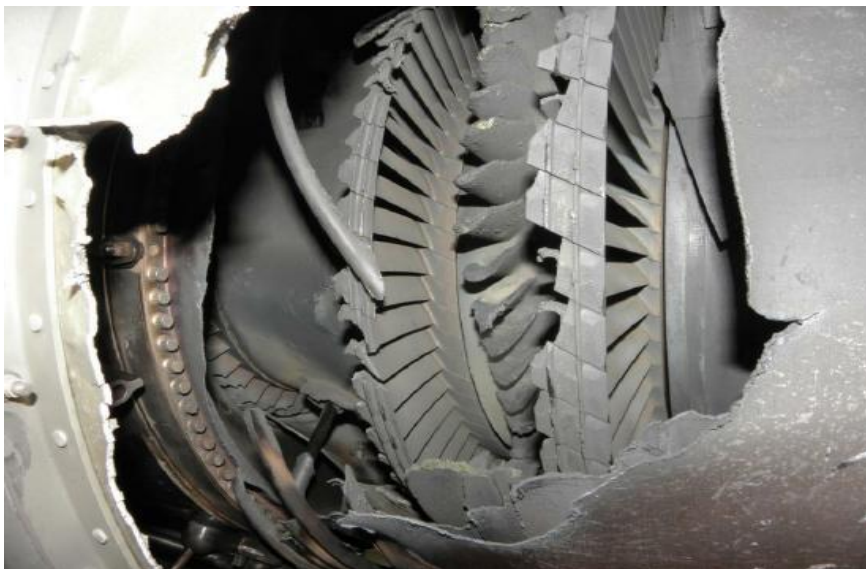
Slika 14. Oštećenje lopatica kompresora motora
