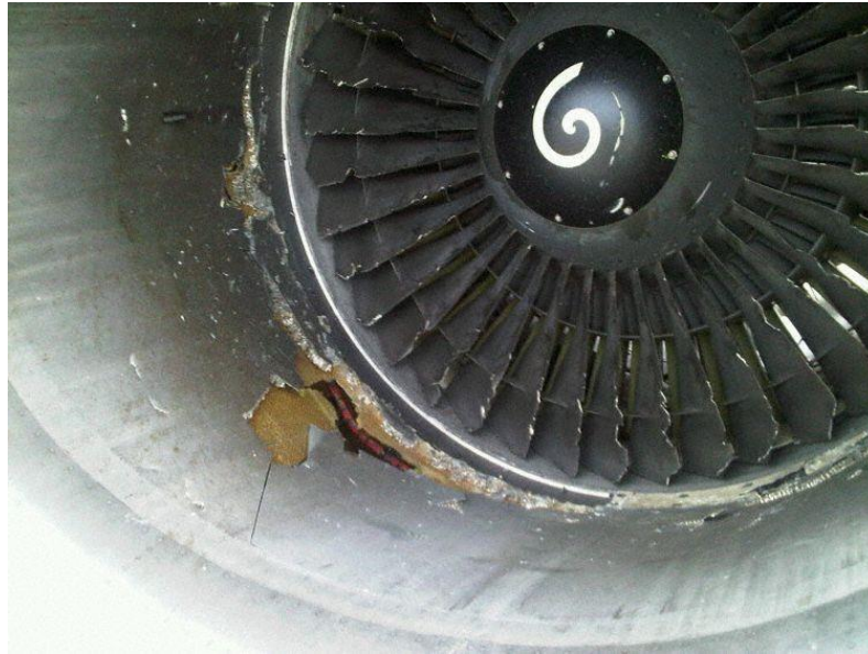
Slika 13. Oštećenje kućišta i lopatica turbo-fan motora
