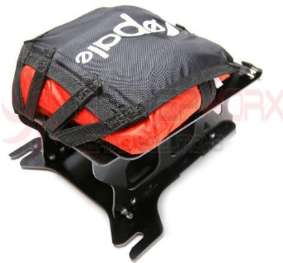
Slika 7. Padobran za bespilotnu letjelicu [15]
