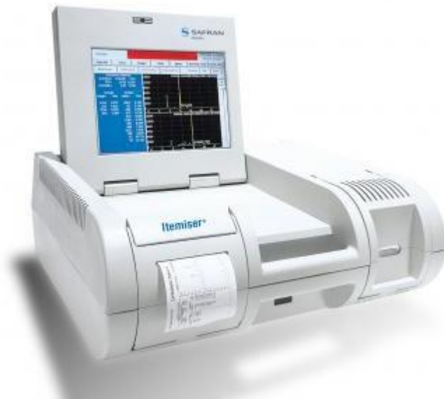
Slika 10. Prijenosni detektor tragova eksploziva i narkotika
