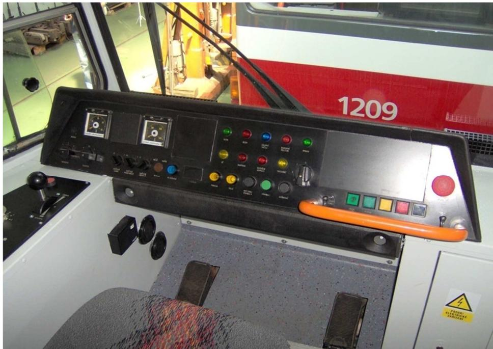
Slika 12. Vozačka kabina u tramvaju T6A5
