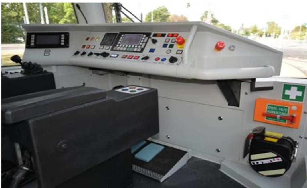
Slika 63. Vozačka kabina u Ultra Low Floor tramvaju
