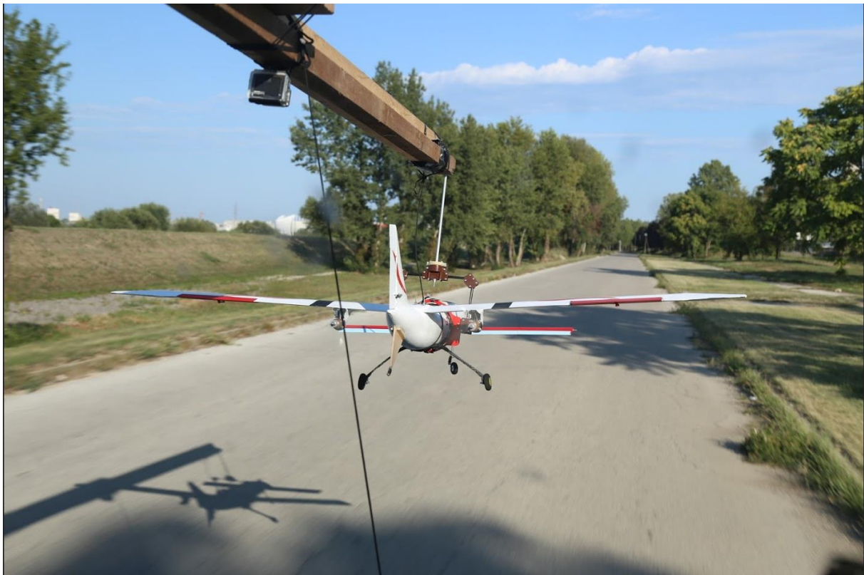
Slika 28 - Testiranje na vozilu u struji zraka
