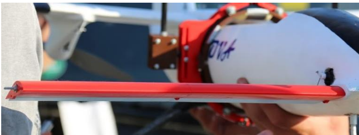
Slika 27 - Ugrađeni kanard (crveno) + kormilo dubine (plavo)
