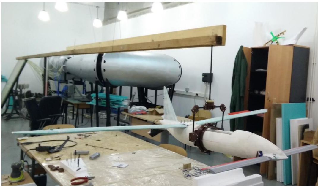
Slika 15 - Letjelica SOVA ovješena na kardanskom ovjesu
