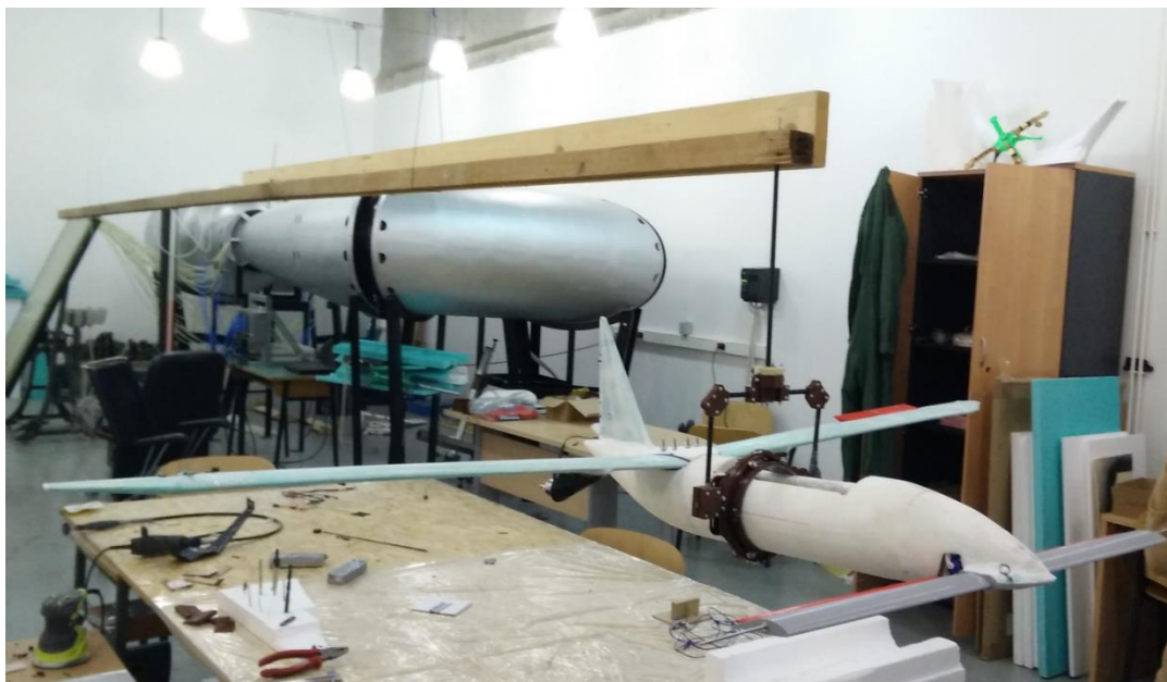
Slika 15 - Letjelica SOVA ovješena na kardanskom ovjesu
