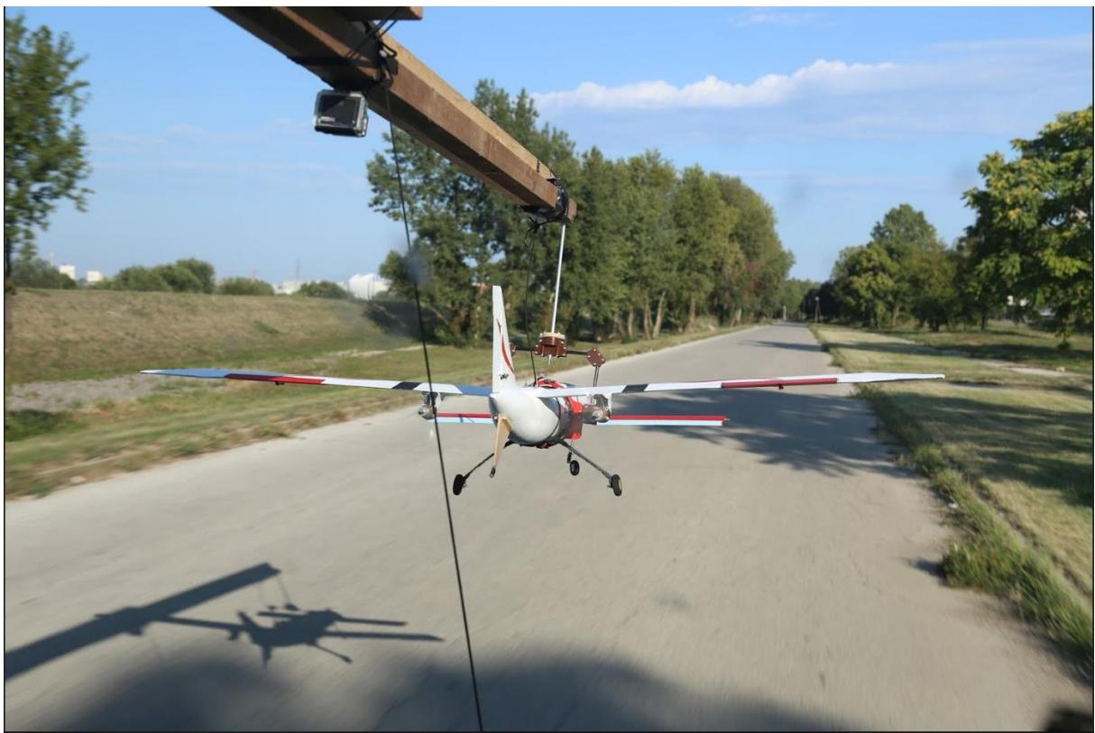
Slika 28 - Testiranje na vozilu u struji zraka
