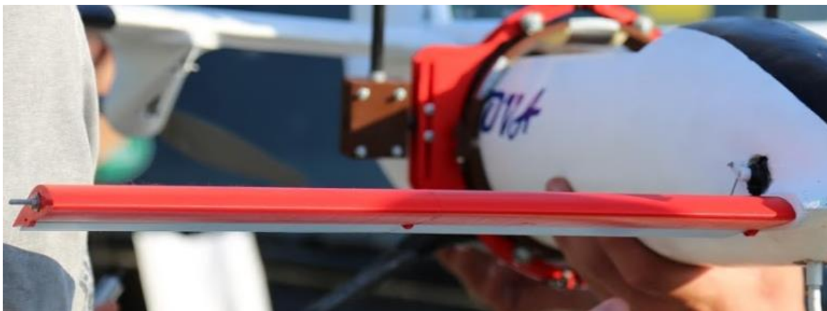
Slika 27 - Ugrađeni kanard (crveno) + kormilo dubine (plavo)
