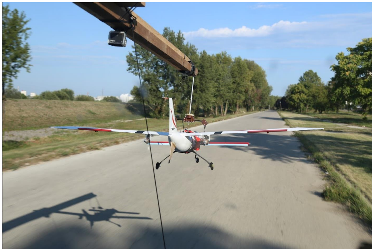
Slika 28 - Testiranje na vozilu u struji zraka
