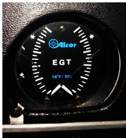
Slika 15:Instrument za mjerenje temperature ispušnih plinova – EGT,[4]
