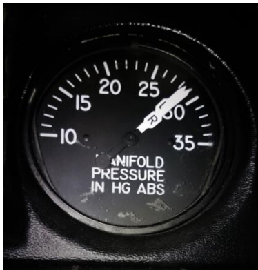
Slika 13: Instrument za mjerenje tlaka punjenja – MAP,[4]
