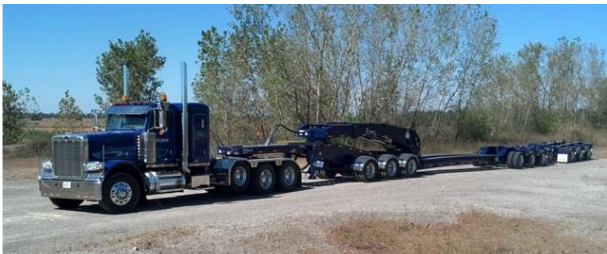
Slika 3 Primjer tegljača i poluprikolice za obavljanje prijevoza specijalnih tereta nosivosti 75t
