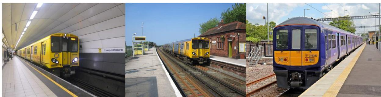
Slika 57 označena s a): Željeznička električna motorna garnitura tipa „Class 507”
