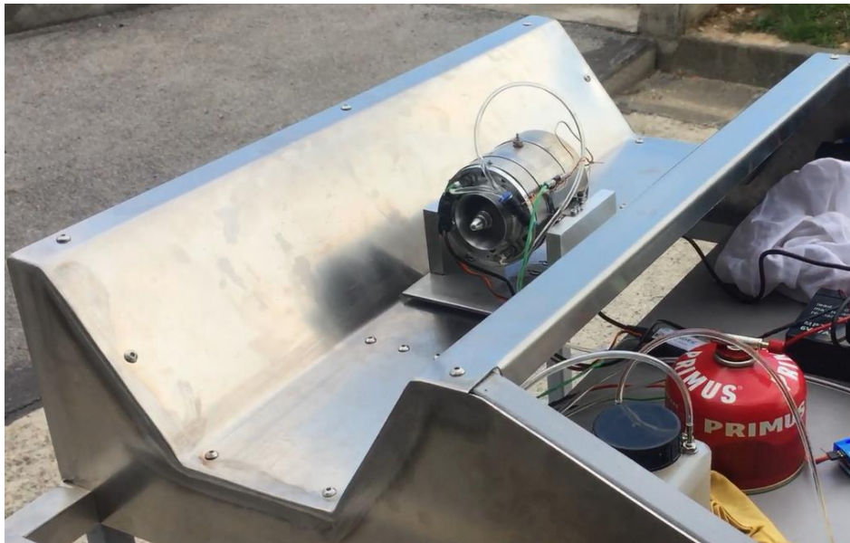
Slika 20. Motor JJ-1400 u radu na probnom stolu
