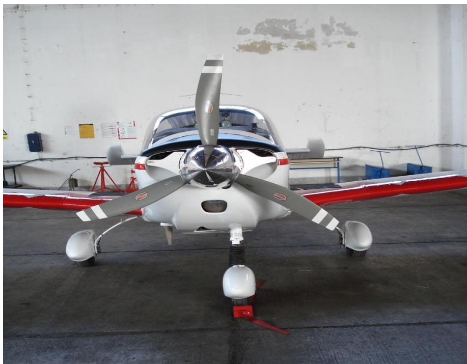
Slika 4. Usisni otvori na prednjem dijelu nosa zrakoplova 10
