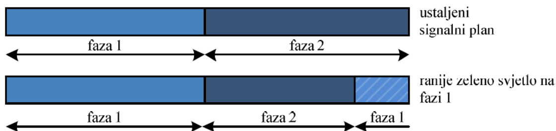
Slika 4: Grafički prikaz tehnike ranije početka zelenog svjetla [5]
