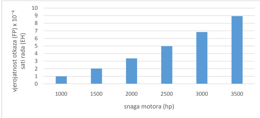
**Dijagram 1.**Vjerojatnost otkaza klipnog motora u odnosu na snagu (RPM=konst.)
