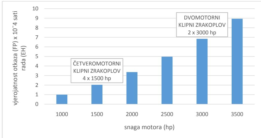
**Dijagram 2.**Usporedba vjerojatnosti otkaza jednog motora dvomotornog i četveromotornog klipnog zrakoplova (RPM=konst.)
