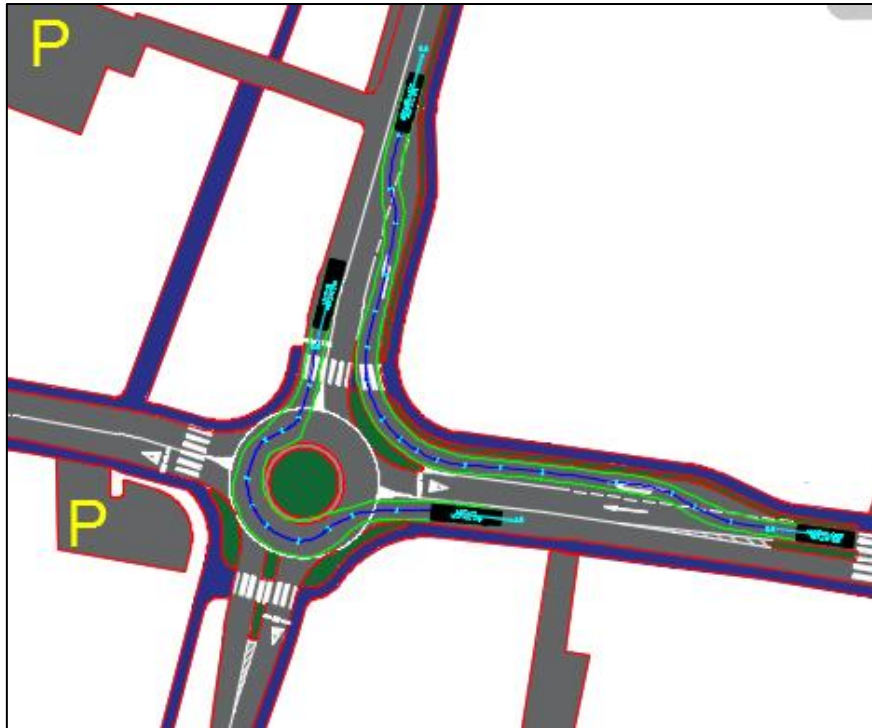
Slika 22. Trajektorija mjerodavnog vozila - Varijanta 2
