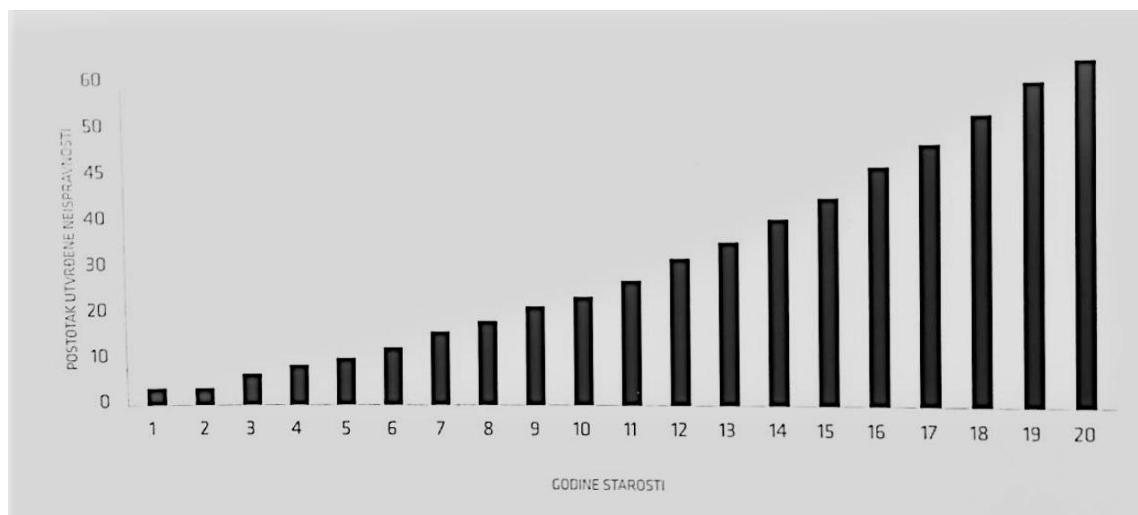
Slika 10. Neispravnost cestovnih vozila ovisno o godini proizvodnje
