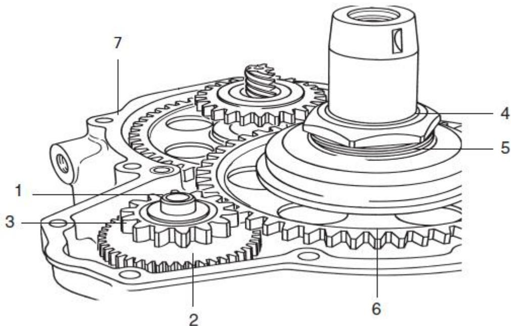
Slika 16. Demontaža jednosmjerne spojke na motoru Rotax 912 S
