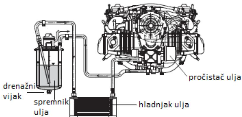
Slika 7. Sustav za podmazivanje na motoru Rotax 912 S
