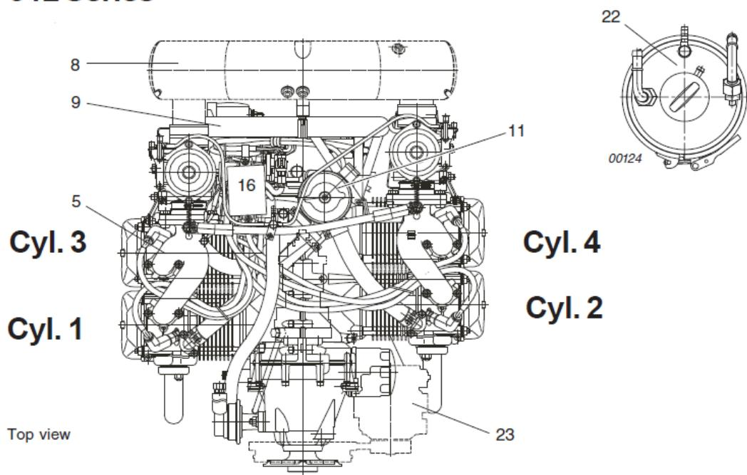
Slika 3. Tlocrt motora Rotax 912 S
