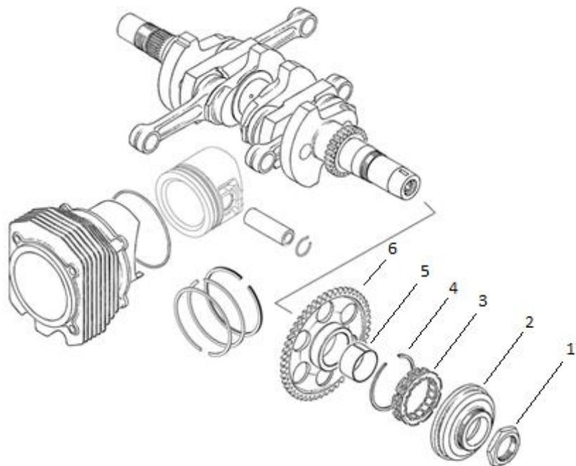
Slika 14. Dijelovi sklopa jednosmjerne spojke na motoru Rotax 912 S
