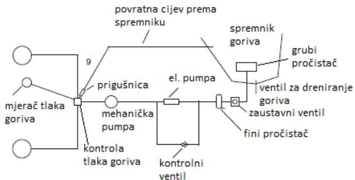
Slika 6. Sustav za napajanje gorivom zrakoplova DV20
