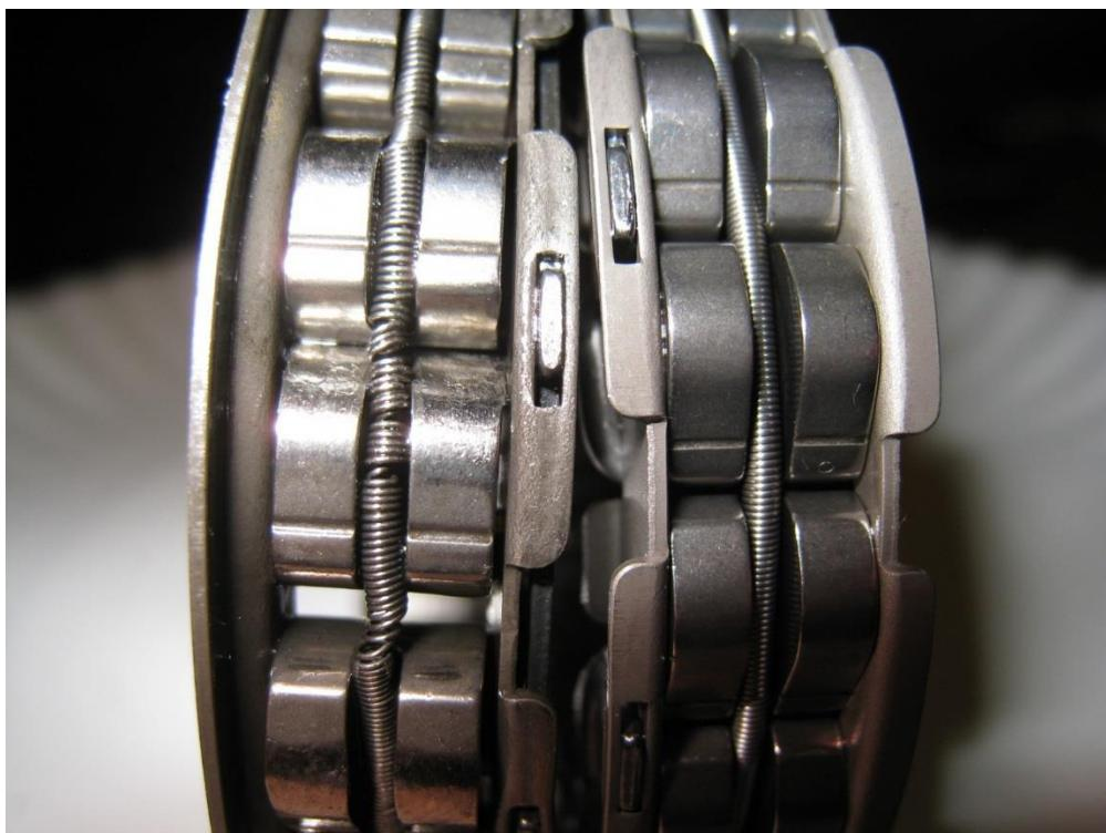
Slika 15. Oštećena jednosmjerna spojka
