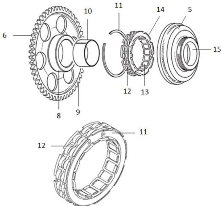
Slika 17. Rastavljanje jednosmjerne spojke
