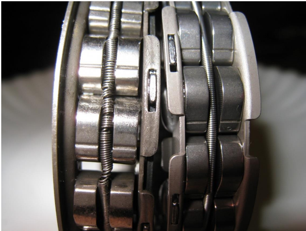
Slika 15. Oštećena jednosmjerna spojka
