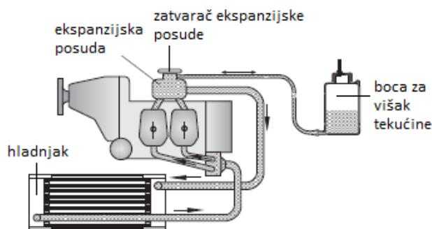
Slika 8. Sustav za hlađenje na motoru Rotax 912 S
