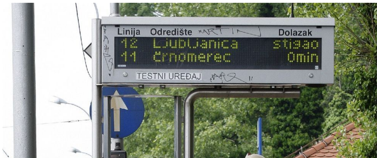
Slika 30. Display informiranja putnika o dolasku vozila na stajalište, [31]
