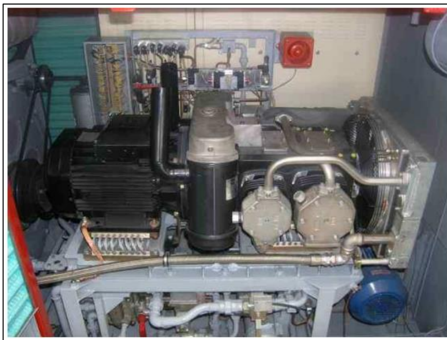
Slika 25. Bezuljni kompresor Knorr VV 270-T
