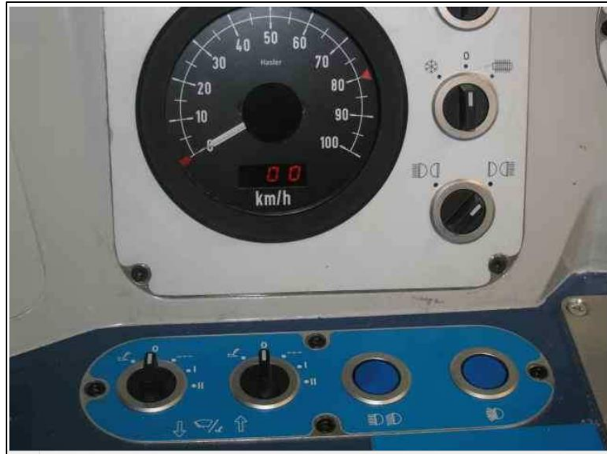
Slika 15. Prekidač rasvjete na upravljačkom stolu
