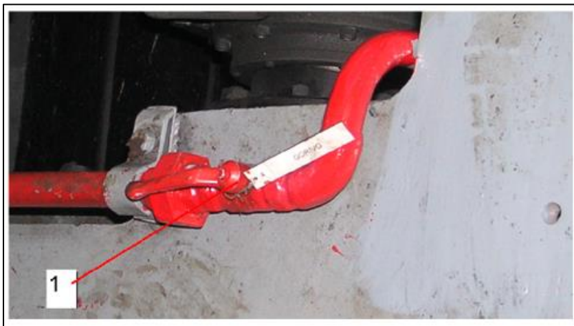
Slika 29. Slavina za zatvaranje napajanja goriva dizel motora (1)
