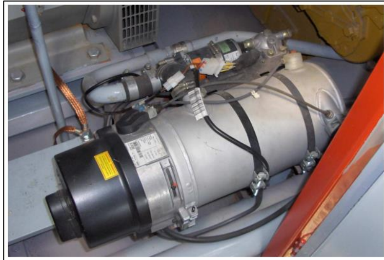
Slika 22. Uređaj za predgrijavanje , Webasto Thermo 230
