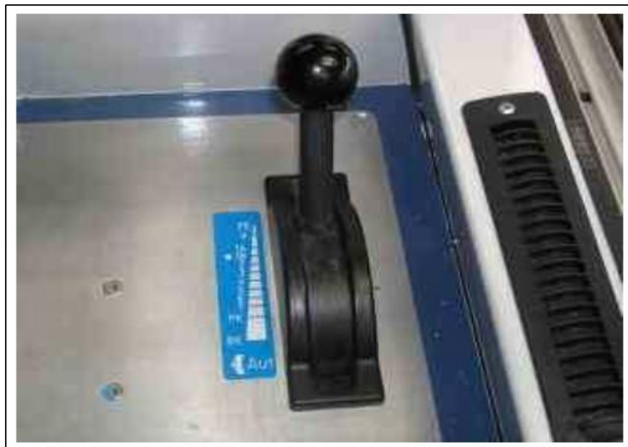
Slika 7. Indirektni kočnik Knorr FBS 1-3 SB2-DA
