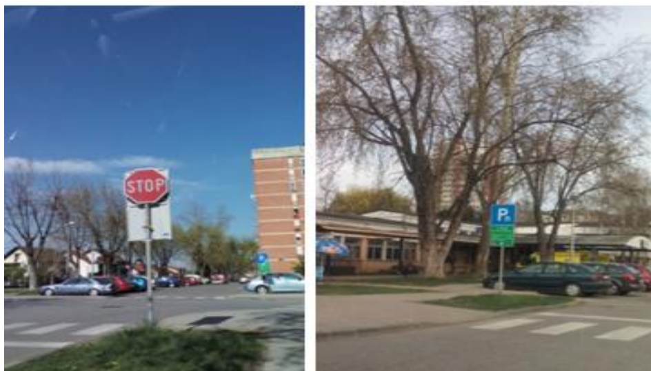
Slika 54. Primjer znaka „obvezno zaustavljanje“ zaklonjenog drugim znakom
