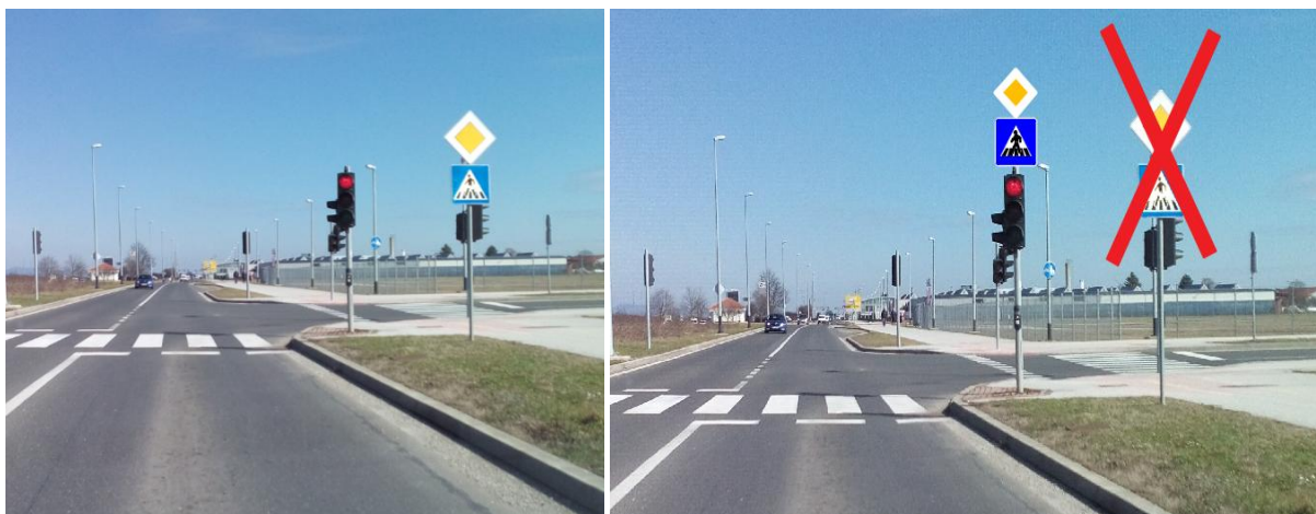
Slika 83. Postavljanje prometnih znakova na semaforski stup
