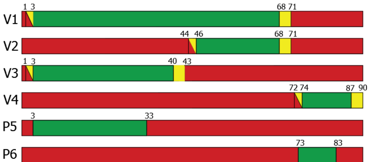
Slika 32. Izgled signalnog plana analiziranog raskrižja, [4]
