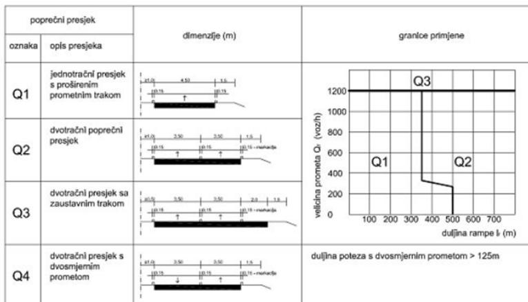
Slika 16. Dimenzije i granično područje primjene spojnih rampi, [1]
