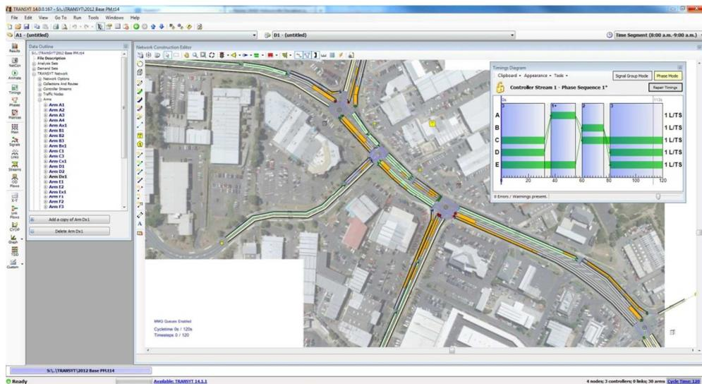
Slika 25. Grafičko sučelje TRANSYT simulacijskog alata, [13]
