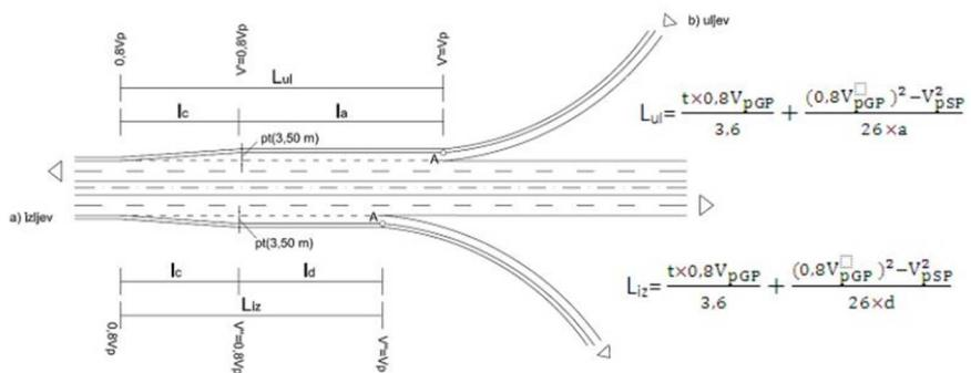
Slika 18. Osnovni elementi za dimenzioniranje izljeva i uljeva, [1]
