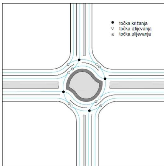
Slika 47. Konfliktne točke u turbo kružnom raskrižju s dvotračnim ulazima, [11]
