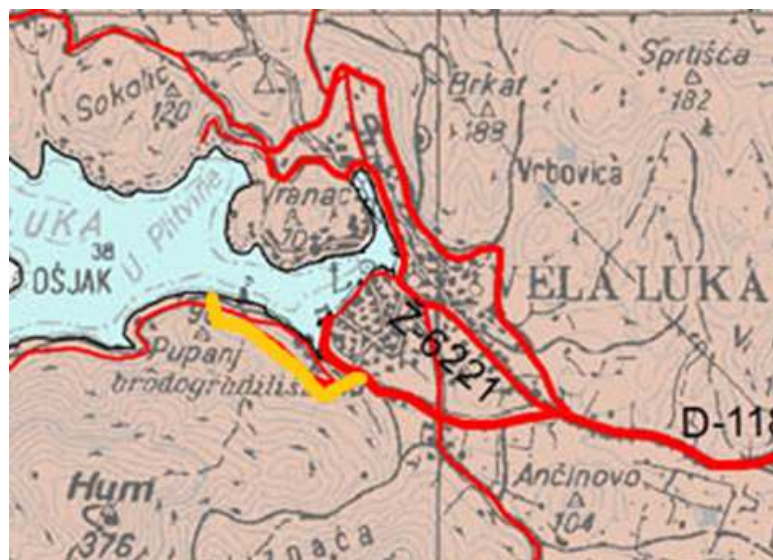
Slika 3. Produžetak trase D- 118 do planiranog trajektnog pristaništa u Veloj Luci (žuto)
