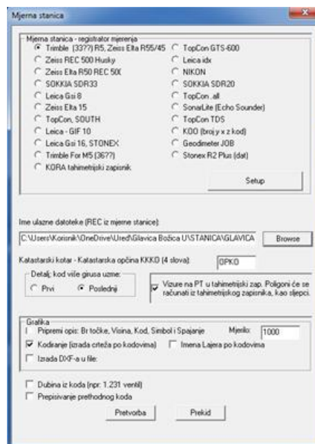
Slika 5.17. Izbornik Mjerna stanica
