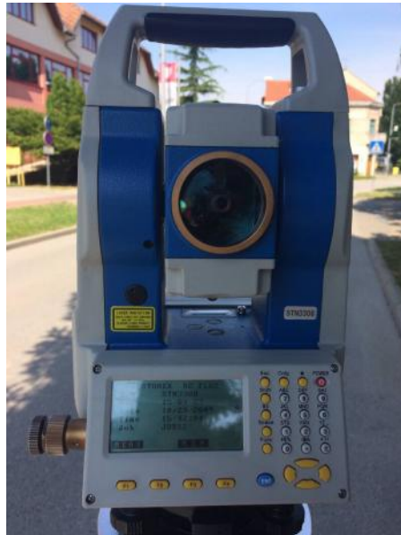
Slika 5.8. Pokretanje totalne stanice
