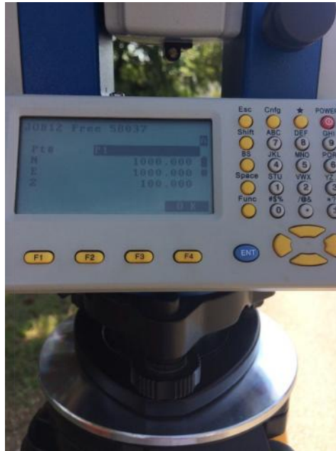
Slika 5.10. Postavljanje koordinata točke P1
