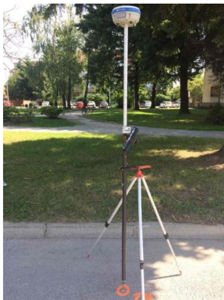
Slika 5.4 Određivanje koordinata poligona GPS prijemnikom
