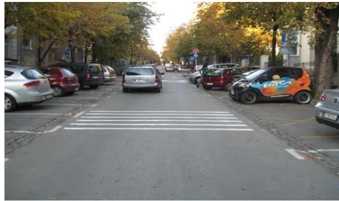
Slika 22. Poprečne vibrirajuće zvučne trake
